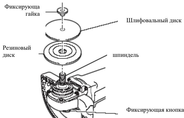
(5) Надавите на кнопку, чтобы предотвратить вращение шпинделя. Затем зарепите диск, затянув ключом гайку для шлифовального диска.
