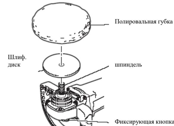
(2) Установите подкладную шайбу на шпиндель.
